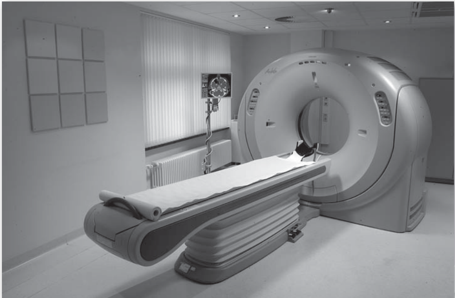
Modernes Mehrzeilen-CT-Gerät. Vorn die Patientenliege, dahinter die Abtasteinheit, in der die nicht sichtbare Röhre kreist.
